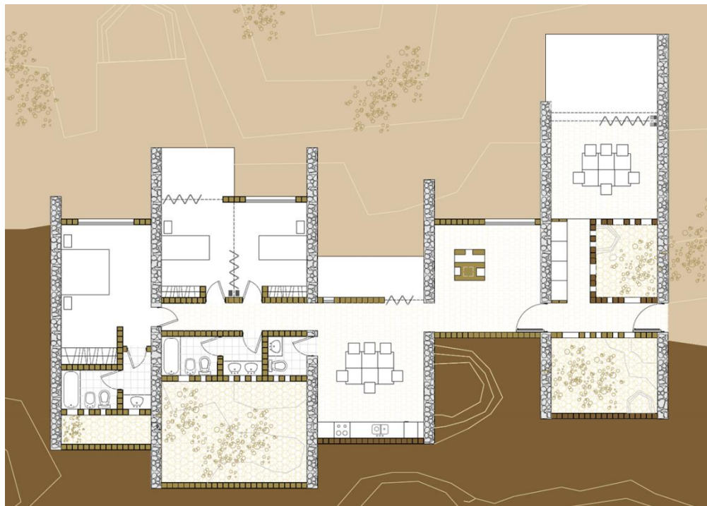
Imagen 8: Planta de Arquitectura. Intervención: vivienda. Incorporación de nuevos espacios de usos domésticos.
