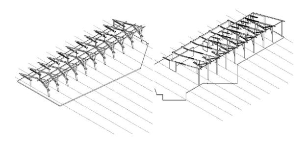
Imagen 11\_ Dibujo lineal. Elaboración propia. Perspectiva axonométrica con las cerchas proyectada por Miguel Angel Odriozola (izquierda). Perspectiva axonométrica con los pórticos finalmente construido.
