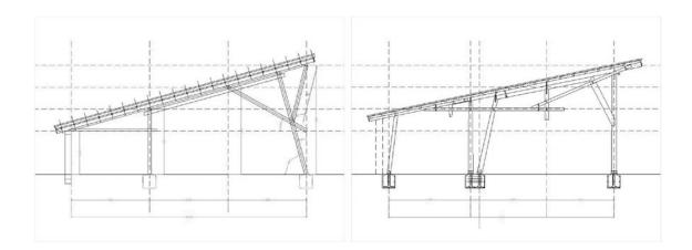
Imagen 10\_ Dibujo lineal. Elaboración propia. Alzado de cercha propuesta por Miguel Angel Odriozola (izquierda). Pórtico construido en 1947, posteriormente reconstruída en 2009 (derecha).
