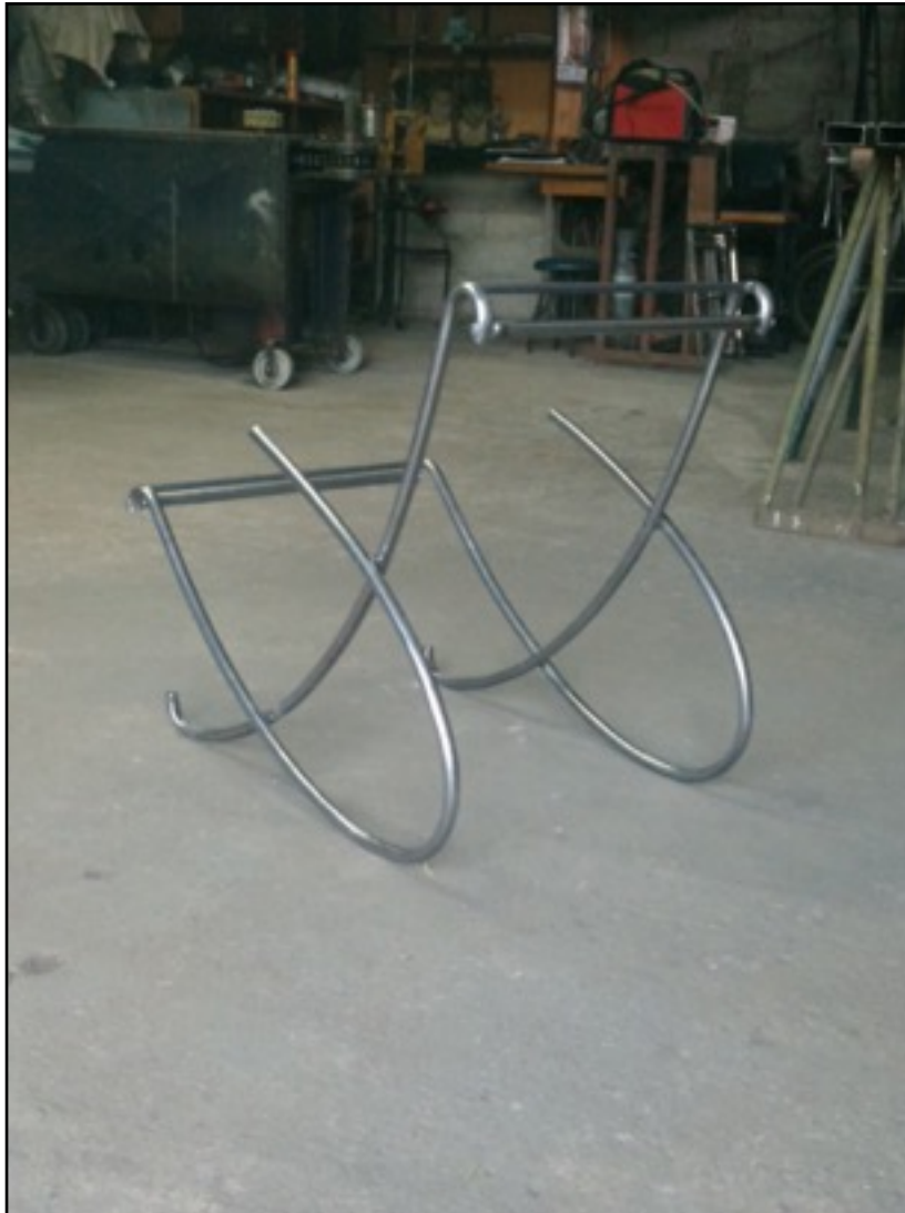
10. Proceso de reconstrucción de la silla RF1. Fotografía en el taller de herrería, primeras pruebas de la estructura de tubo de acero.
